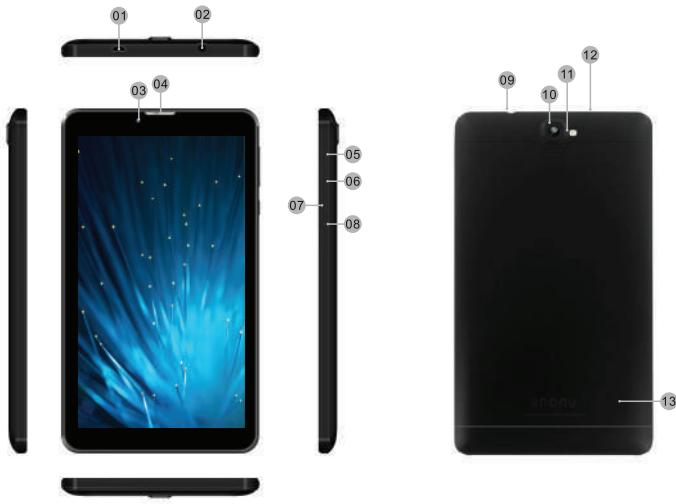
**1) Interface Micro USB:** La interface Micro USB puede leer y escribir discos u/o disco duro extraible y otros datos del equipo.
